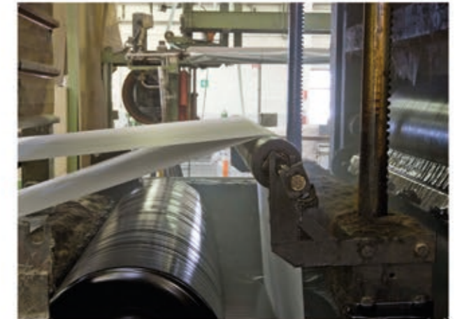
Die beiden Trägereinlagen werden in die Imprägnier- und dann in die Beschichtungsplanne geführt.
